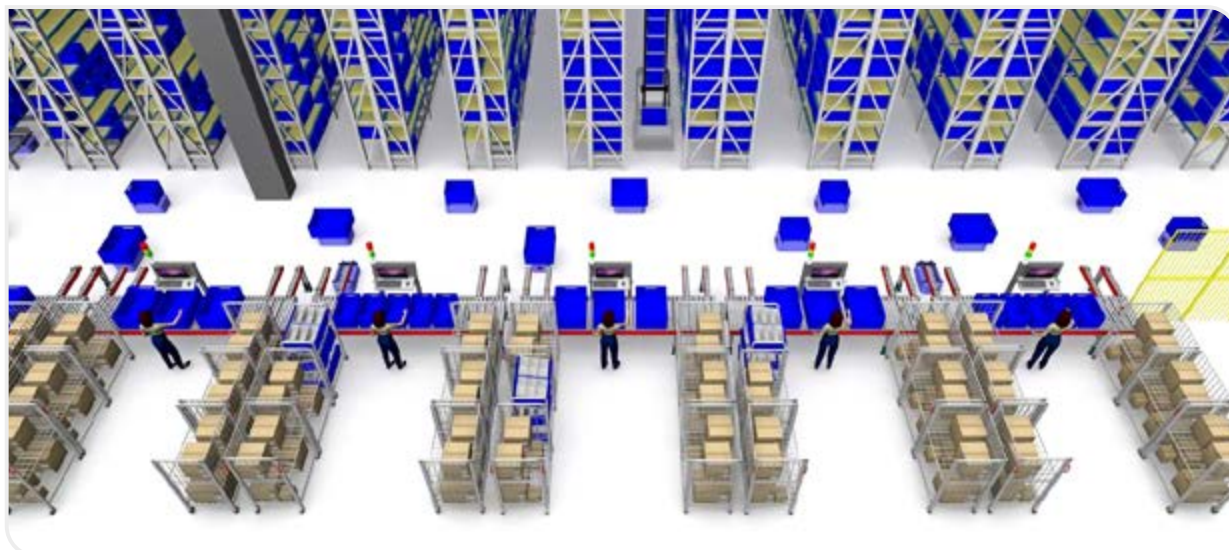
Rys. 2. // Stacje kompletacyjne połączone z systemem robotycznym poprzez układ przenośników (źródło: materiały własne LLS)
