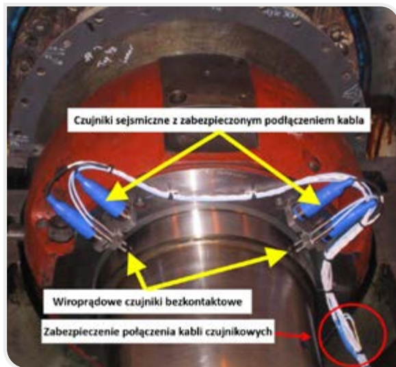
Rys. 3. // Redundantne pomiary drgań TZ
