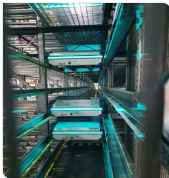
Fot. 2. // Roboty wewnątrz systemu shuttle (źródło: materiały własne LLS)
