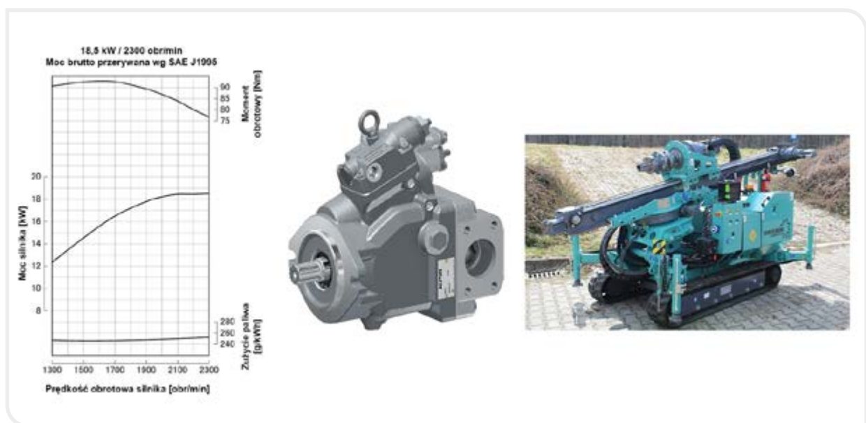
Rys. 3. // Wiertnica samojezdna wyposażona w pompę zmiennej wydajności z regulatorem LS / PC / stałej mocy.
