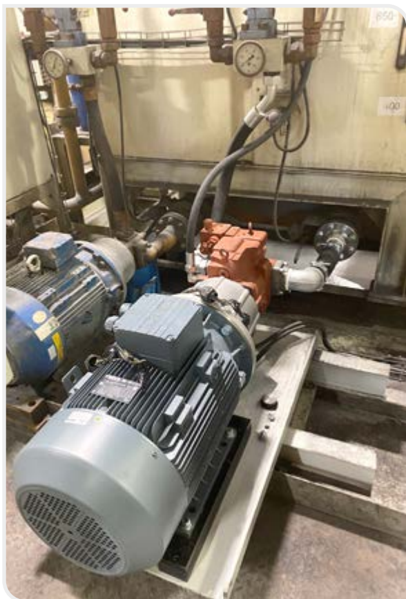
Rys. 1. // Pompa zębata vs. pompa zmiennej wydajności z regulatorem PC na zasilaczu klienta.
