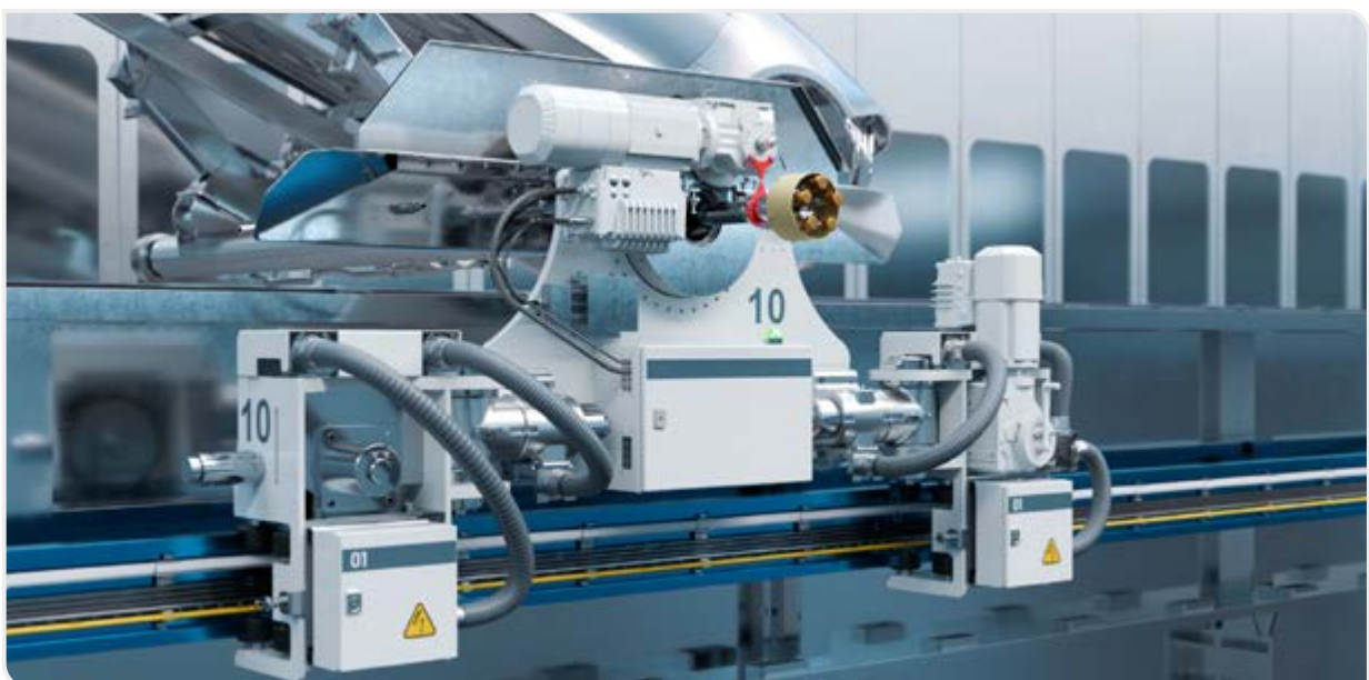
Ilustracja 1. // RoDip E zy jest oparty na kompaktowej przekładni cykloidalnej.
