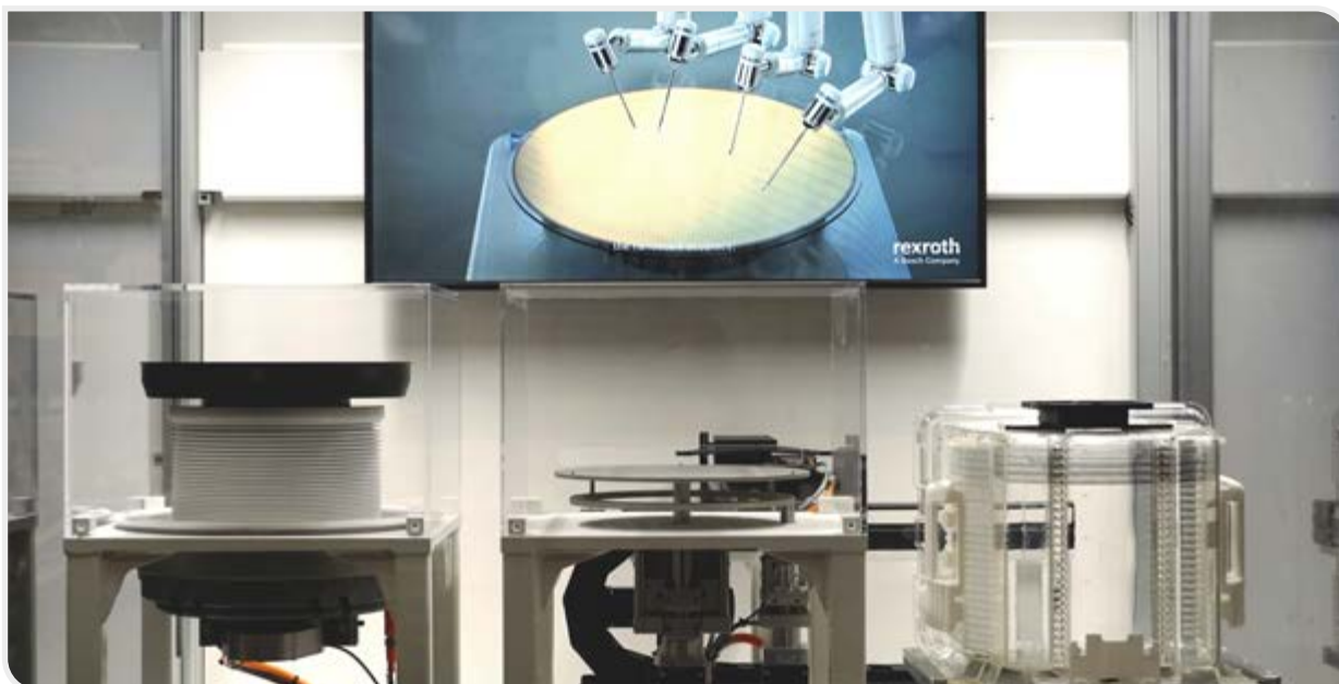
Fot. 1. // Technologia napędów i sterowania, a także technika przemieszczeń liniowych i technika montażu w demonstratorze do manipulowania płytkami półprzewodnikowymi (Zdjęcie: Bosch Rexroth AG)
