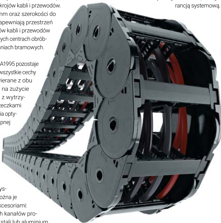
Fot. 2. // Dzięki UNIFLEX Advanced 1995 firma TSUBAKI KABELSCHLEPP posunęła się o krok dalej w zakresie systemów przeznaczonych do większych przekrojów przewodów i węży. Wysokość wewnętrzna 80 mm i szerokość do 600 mm zapewniają miejsce na skomplikowane wiązki przewodów i węży – na przykład w wielofunkcyjnych centrach obróbkowych lub w złożonych systemach bramowych. Zdjęcie: TSUBAKI KABELSCHLEPP
