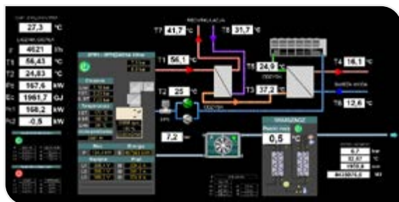
Rys. 5. // Panel sterowania i kontroli wszystkich parametrów w sprężarkowni, Źródło: Ingersoll Rand
