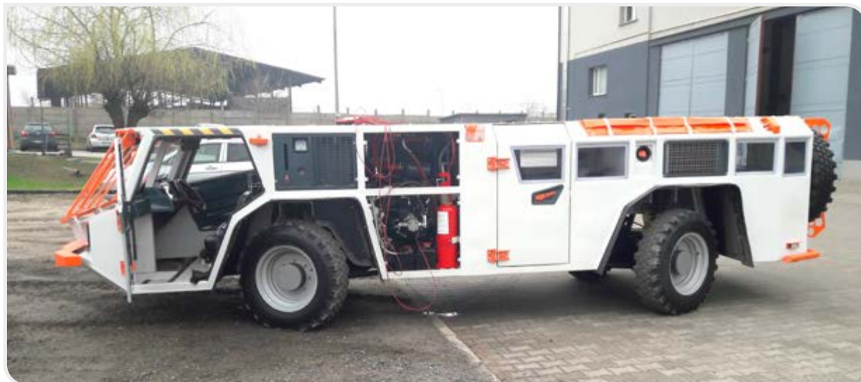
Rys. 2. // Pojazd transportowy firmy DESIM wyposażony w system Automotive PLUS+1, opracowany wspólnie z BIBUS MENOS z myślą o przewożeniu ludzi w kopalniach KGHM.
