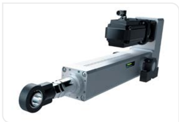
Fot. 1. // Nowe siłowniki elektromechaniczne o dużej mocy z serii EMC-HP w rozmiarach 190 i 220 umożliwiają efektywną implementację przy wymagających zastosowaniach do 250 kN – przyszłościowe rozwiązanie łączące maksymalną wydajność i wytrzymałość z niskimi kosztami projektowania, użytkowania i konserwacji. (Źródło obrazu: Bosch Rexroth AG)
