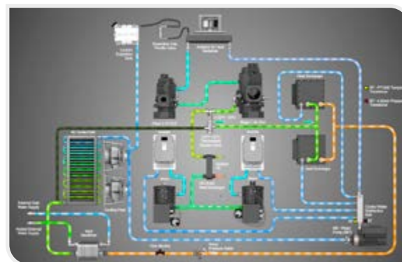
Rys. 4. // Wewnętrzny obieg chłodzenia sprężarki Ingersoll Rand E160ne (chłodzonej powietrzem) z możliwością odzysku energii, źródło: Ingersoll Rand
