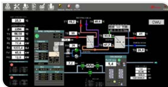
Rys. 3. // Panel sterowania i kontroli wszystkich parametrów w sprężarkowni, źródło: Ingersoll Rand
