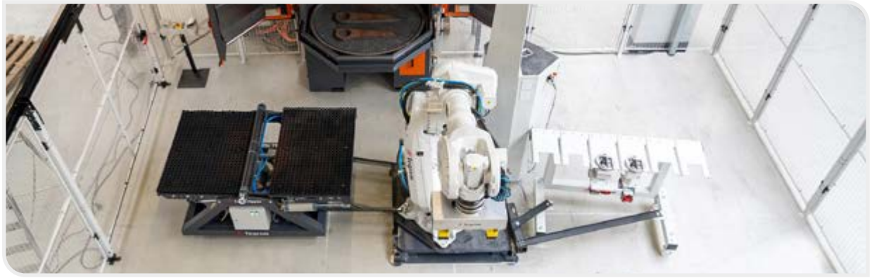
Fot. 2. // Gniazdo produkcyjne o wymiarach 8x8 m składa się z inteligentnego robota stacjonarnego i urządzenia do obróbki strumieniowo-ściernej Rösler RDT 150 ze stołem obrotowym, wyposażonego w dwie turbiny o wysokiej wydajności.
