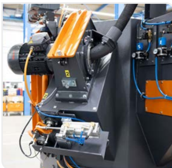
Fot. 1. // Dwie wysokowydajne turbiny Gamma 300G z łopatkami wyrzucającymi w kształcie litery Y zapewniają krótkie cykle obróbki strumieniowo-ścierniej i energooszczędną pracę.
