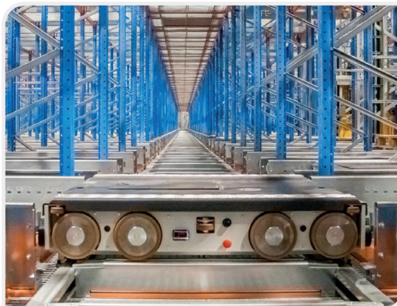
Fot. 2. // Wózek typu robot AGV (źródło: STOW)
