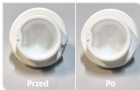
Fot. 1. // Detal przed i po czyszczeniu formy suchym lodem
