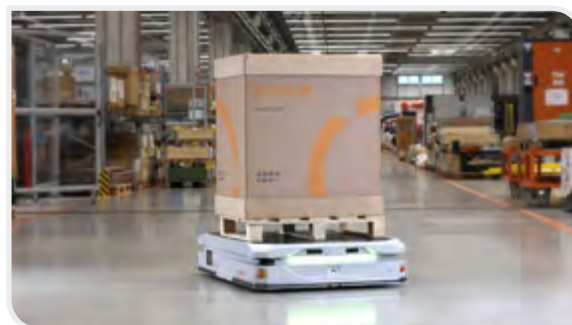
Fot. 2. // Za pomocą KMP 1500P można transportować do półtorej tony różnych materiałów i elementów obrabianych.
