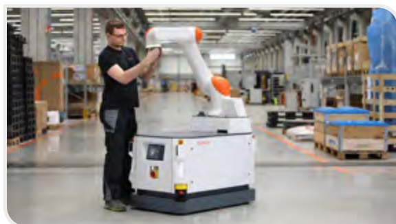
Fot. 1. // Mobilny kobot KMR iisy składa się z robota LBR iisy o udźwigu 11 lub 15 kg i mobilnej platformy.
