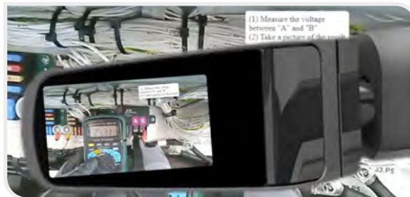
Fot. 1. // Kontrola izolacji w rozwiązaniu SkillWorx na urządzeniu RealWear HMT-1 z etykietami AR zakotwiczonymi w fizycznym elemencie wyposażenia autobusu.
