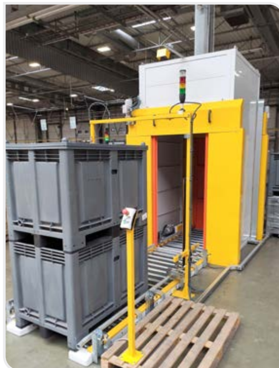
Fot. 3. // Prototyp komory do realizacji spisu z natury Źródło: opracowanie własne Łukasiewicz – Poznański Instytut Technologiczny
