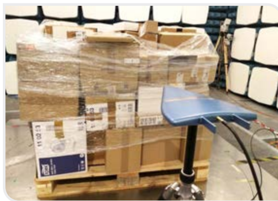
Fot. 1. // Stanowisko pomiarowe z paletą jednostką ładunkową w komorze bezodbiciowej. Źródło: opracowanie własne Łukasiewicz – Poznański Instytut Technologiczny
